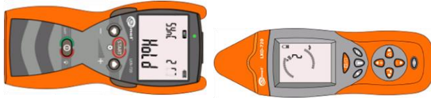
Abb. 5 Positionierung der Sende- und Empfangseinheit während der Synchronisation
